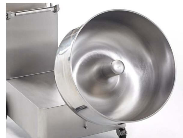
Haute colonne centrale dans la cuve MIX165.
